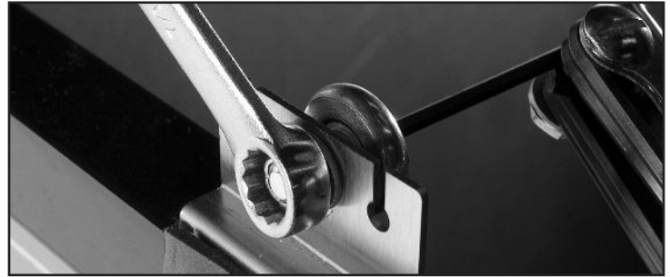
Fig. 1. Adjust the roller.
